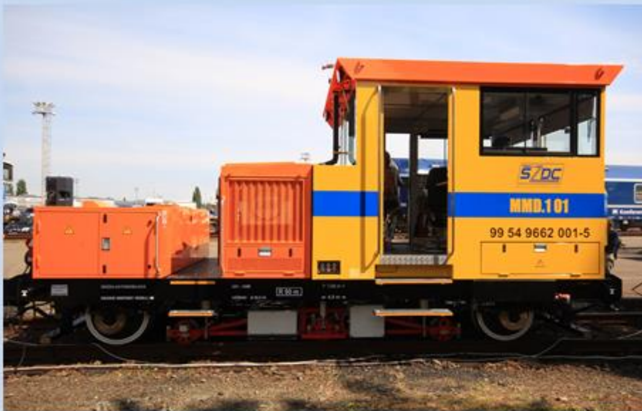
Měřicí drezíny MMD – měření dopravních staničních kolejí
