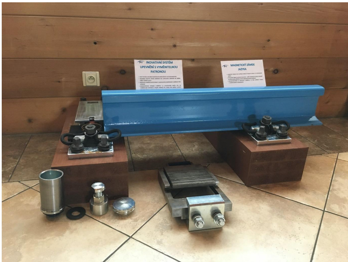
Obr. 3 Ukázka demonstrátoru – plastové pražce, inovativní systém upevnění, v popředí demontovaný magnetický zámek
